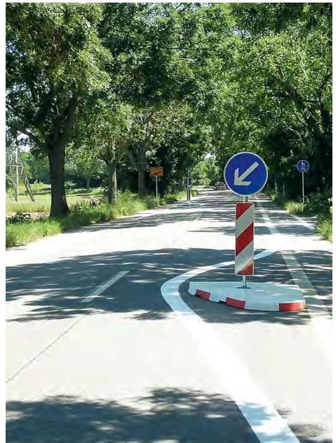
Besonders gute Sichtbarkeit und Wahrnehmung, durch rot-weiß reflektierenden Inselrand.
