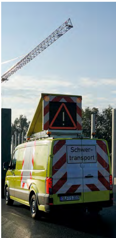
Die LED-Wechselzeichengeber sind mit vorschriftsmäßiger Folie beklebt und entsprechen der europäischen Norm EN 12966.
