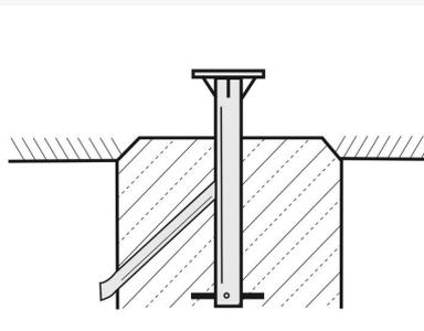
Sockelpfosten mit Kabelführungsrohr
