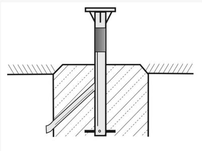
Sockelpfosten für Kabelanschlusskasten
