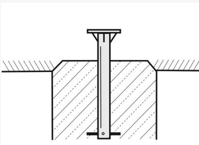
Sochelpfosten zum Einbetonieren
